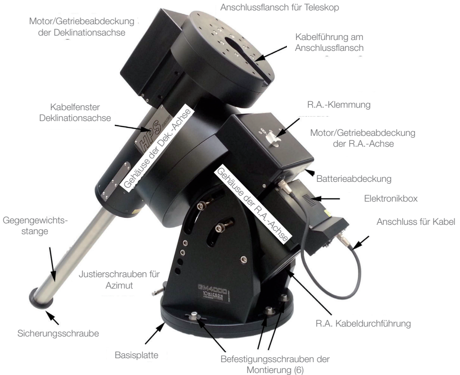
Abb. 4.6: Die Bauteile der GM4000HPS II
