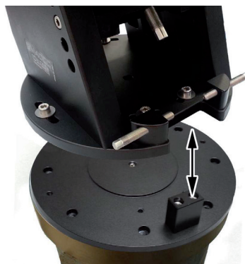
Abb. 4.10: Ausrichten von Montierung und Basisplatte aufeinander
