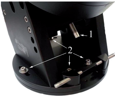
Abb. 4.21: Die Schrauben zur Justage der Polhöhe
