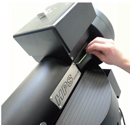
Abb. 4.13: Zugriff auf den Kabeldurchlass der Deklinationsachse
