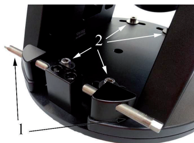
Abb. 4.22: Die Schrauben zur Justage des Azimutwinkels
