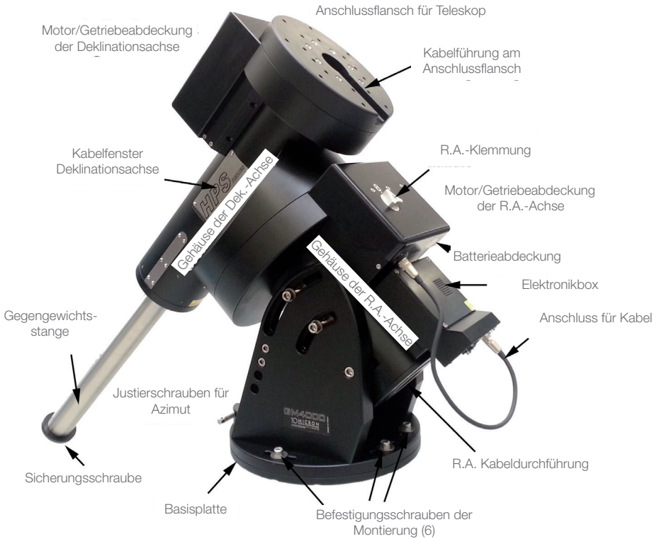
Abb. 4.6: Die Bauteile der GM4000HPS II
